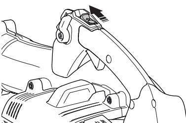
**ВНИМАНИЕ!** Контакт остановки автоматически возвращается в положение запуска. Во избежание непроизвольного запуска, колпачок зажигания следует всегда снимать со свечи зажигания при монтаже, проверке и/или обслуживании.
