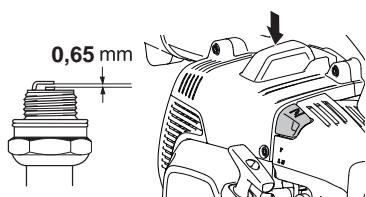
**ВНИМАНИЕ!** Всегда используйте только указанный тип свечи! Применение несоответствующей модели может привести к серьезным повреждениям поршня/цилиндра. Следите за тем, чтобы свеча была оснащена т.н. изоляцией радиопомех.
