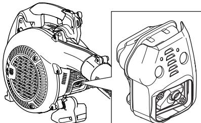
Если глушитель на вашей машине дополнительно оборудован искрогасящим фильтром, его следует регулярно прочищать. Забившийся фильтр может вызвать перегрев двигателя и привести к серьезным повреждениям двигателя.
